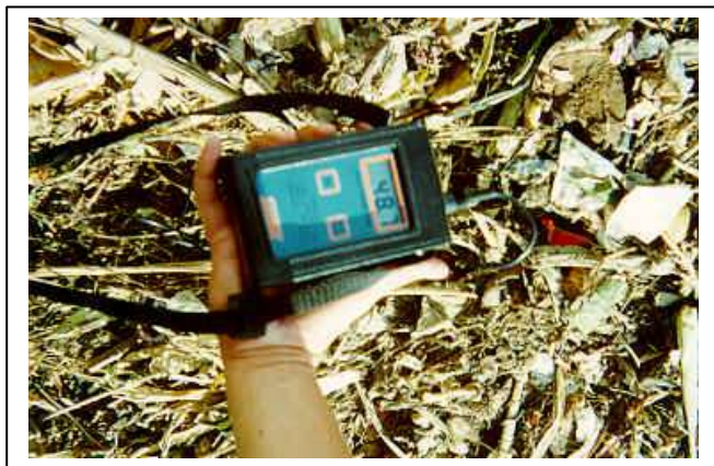
Foto 28 - Medição de Temperatura da Leira
